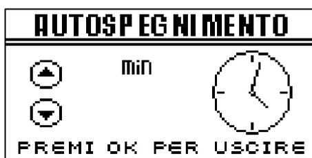
Permette di impostare il tempo dopo il quale, se la macchina non viene utilizzata, si spegne. E' possibile selezionare un valore da 1 a 20 minuti.
